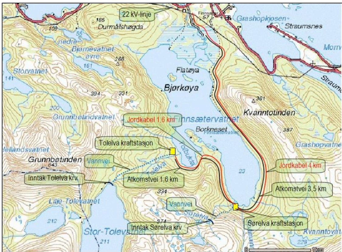
Figur 3. Utbyggers kart som viser planlagt permanent adgang og nettilknytning for Tolelva og Sørrelva kraftverk.
